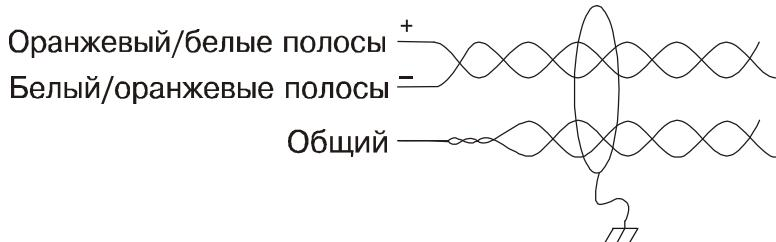
**Примечание.** Для подключения к N-485 соедините вместе провода синего цвета и используйте их как общий провод (сигнальное заземление). Используйте оранжевую пару проводов для передачи данных, соблюдая полярность подключения. На одном конце линии соедините внешнюю оплетку проводников с электрическим заземлением.
