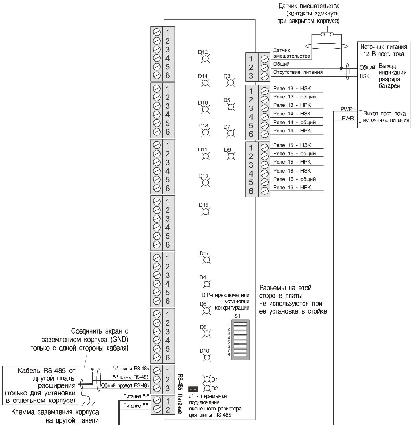
**Примечание.** Для подключения к N-485 соедините вместе провода синего цвета и используйте их как общий провод (сигнальное заземление). Используйте оранжевую пару проводов для передачи данных, соблюдая полярность подключения. На одном конце линии соедините внешнюю оплетку проводников с электрическим заземлением.
