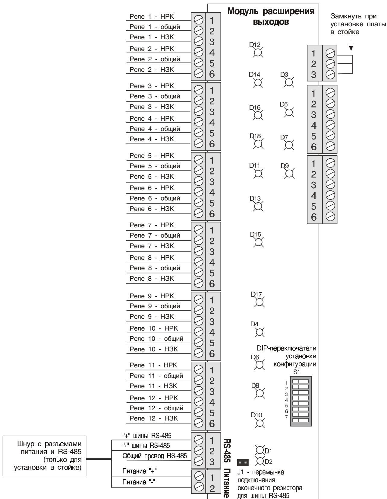
**Примечание.** Для подключения к N-485 соедините вместе провода синего цвета и используйте их как общий провод (сигнальное заземление). Используйте оранжевую пару проводов для передачи данных, соблюдая полярность подключения. На одном конце линии соедините внешнюю оплетку проводников с электрическим заземлением.
