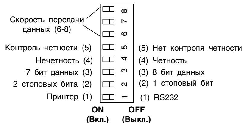
Рис. 2. Установки DIP-переключателя.
